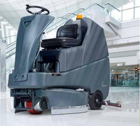
La TRG720 est une autolaveuse autoportée et autotractée (marche avant/arrière). Elle est équipée de 4 batteries gel (ou 6 - version 300T) sans entretien et chargeur intégré - autonomie de 3h30 max (ou 5h30 - version 300T). Elle possède des réservoirs de 120L et 2 brosses de lavage pour une largeur de travail de 720mm.
